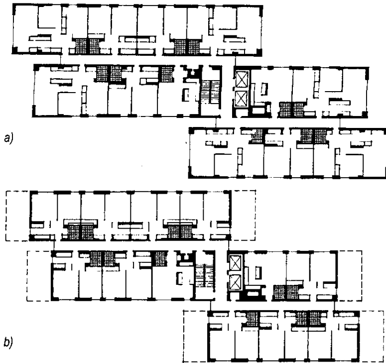
Hình 2.118. Tầng điển hình nhà ở cao tầng kiểu hành lang giữa. Các KTS. Davis, Brody và cộng sự. Mỹ; a) Mặt bằng tầng số chẵn; b) Mặt bằng tầng số lẻ.
