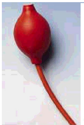
Hình 5. Quả bóp cao su dùng để nối pipét
