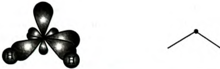
Hình 2.11. Sơ đồ xen phủ các orbital và hình học phân tử của nước
